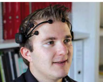
**Elektroden messen die Gehirnströme eines SimTech-Mitarbeiters. Sie werden in Steuerungsbefehle für Computer umgesetzt.**
