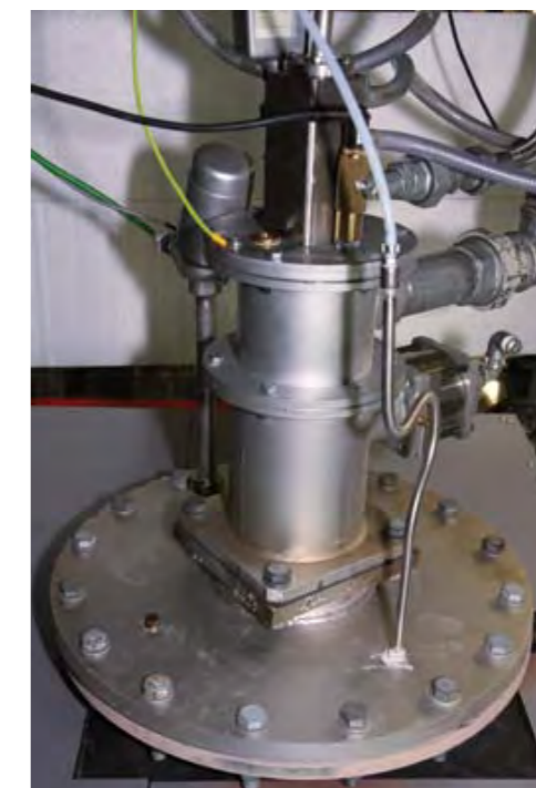
Ein zusammen mit der Firma E-Flox entwickelter Brenner für flüssige biogene Brennstoffe wird in KIC-InnoEnergy für den kommerziellen Einsatz weiterentwickelt. A burner for fluid biogenic fuels, developed with E-Flox Company, now undergoing further development in KIC-InnoEnergy for commercial use.
