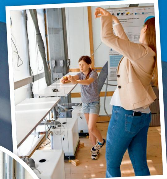
Im zehnten Stock des Testgebäudes schaut sich Lotte Hydroskin und die Wassertanks an. Hier wird das Regenwasser gespeichert: An heißen Tagen wird die Fassade über Düsen mit dem Wasser besprüht, das kühlt. Man könnte mit dem Wasser aber auch Pflanzen gießen oder die Toilette spülen.
