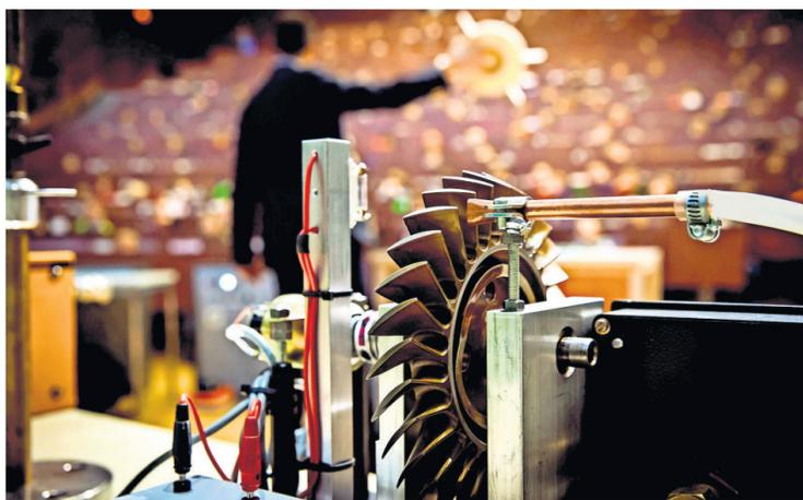
**Effektiv** Ein Luftstrom treibt das Schaufelrad an: je stärker der Luftstrahl, desto schneller wird das Rad – und dabei wird es ziemlich laut.
