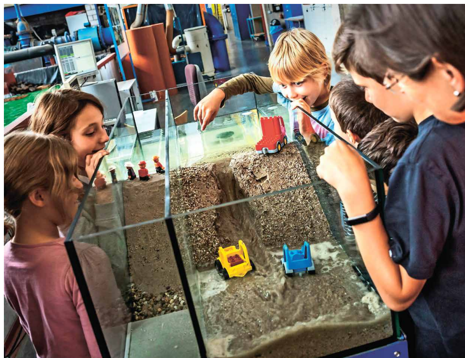
Das Labor für die Wasserbau-Experten an der Uni Stuttgart ist eine riesige Halle. Hier ist derzeit ein Modell eines Rückhaltebeckens nachgebaut, das Einwohner einer Stadt vor Hochwasser schützen soll. Die Nachwuchsstudenten simulieren Hochwasser, das Becken läuft wie eine Badewanne voll – aber der Damm hält! An zwei Modellen im Glaskasten zeigt Silke Wieprecht, warum ein Damm aus feinem Sand irgendwann dem Druck des Wassers nachgibt. Der ehemals feste Sandwall wird zum nassen Brei, bricht zusammen und nimmt alles mit – im Modell sind dies Spielzeugfiguren. Sehr viel besser hält der Damm, wenn am Boden eine Drainage aus Kies das Wasser sammelt. Fotos: Lichtgut/Julian Rettig
