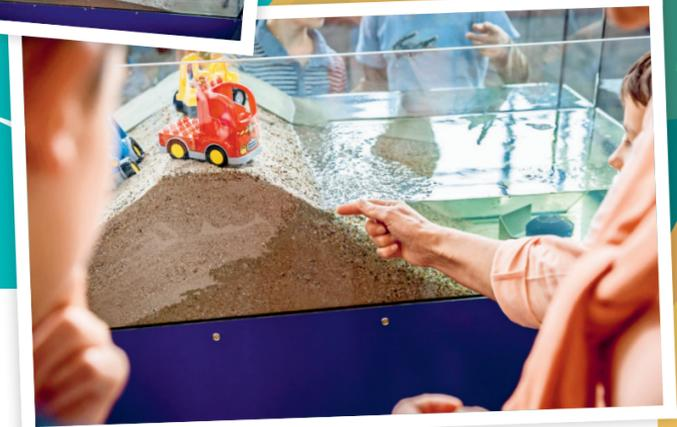
Der Damm mit der Drainage am Boden hält: Das Wasser fließt durch die groben Kieselsteine, und es ist eine Sickerlinie zu erkennen, also die Grenze zwischen trockenem und feuchtem Material. Unten sammelt sich das Wasser, oberhalb der Linie ist der Sand trocken und stabil.
