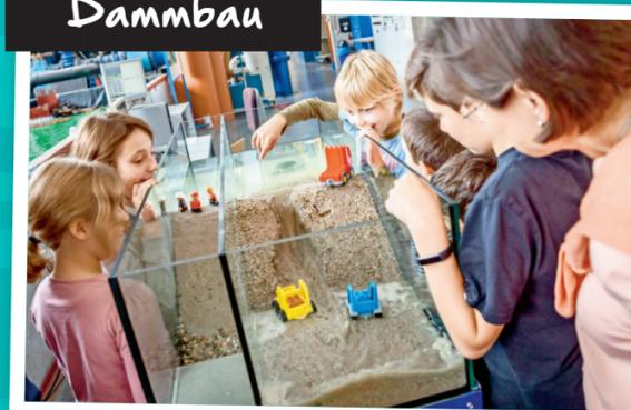
An zwei Modellen im Glaskasten zeigt sich: Der Damm aus reinem feinem Sand hält den Druck des Wassers irgendwann nicht mehr aus. Der ehemals feste Sandwall wird zum nassen Brei, bricht zusammen und reißt alles mit sich, samt den Spielzeugfiguren. Der Damm daneben hält: Eine lockere Schicht aus Kieselsteinen (Drainage) hält das Wasser auf.
