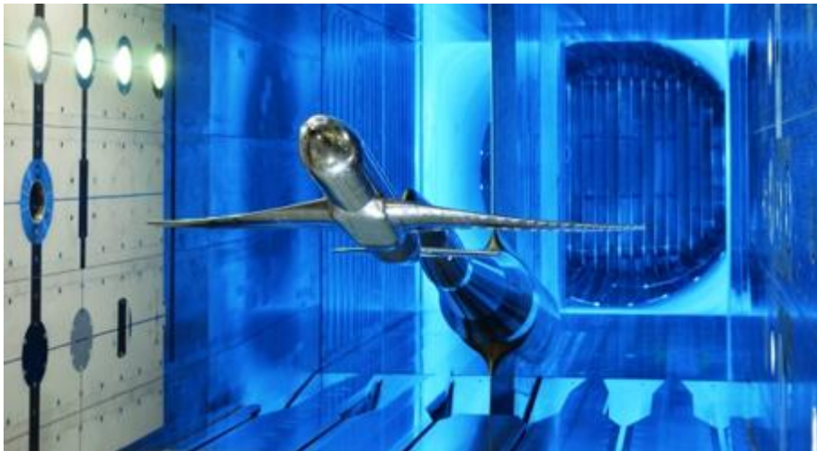
Messungen an einem Transportflugzeugmodell im Europäischen Transsonischen Windkanal. Abbildung: ETW)
