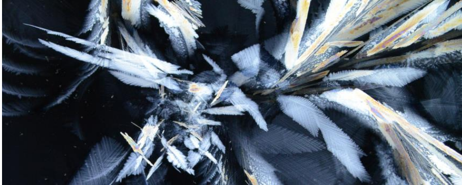
Dendritische Strukturen wachsen in unterkühltem Wasser und beeinflussen Prozesse in Wolken. Foto: Universität Stuttgart / ITLR
