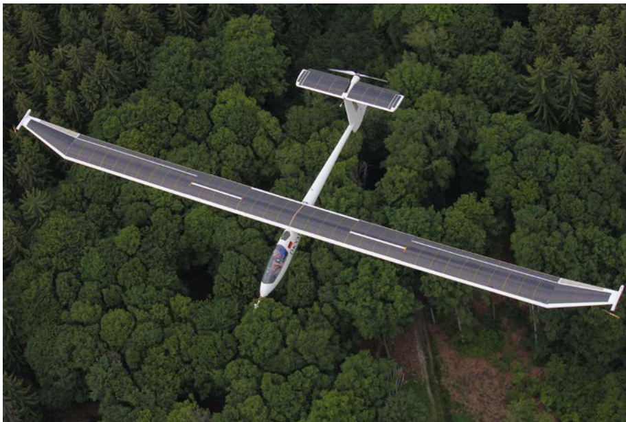
Das Experimentalflugzeug Icaré 2 bei einem Testflug mit elektrischen Flächenendpropellern.
