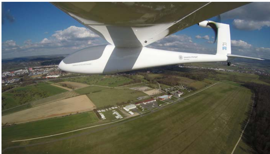
Ein skaliertes, unbemanntes Elektroflugzeug des Typs e-Genius. Es dient zur Erforschung alternativer Antriebskonzepte für energieeffiziente und leise Flugzeuge. Foto: IFB/iFR/IAG
