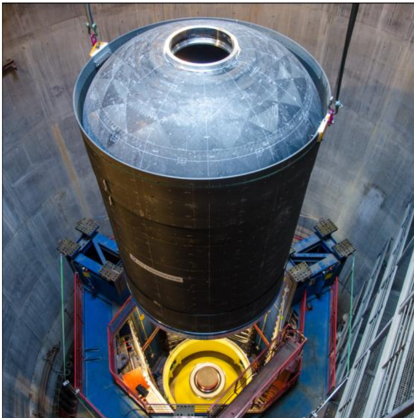
Der Booster-Demonstrator im 32 Meter tiefen Prüfschacht der MPA. Foto: Universität Stuttgart/MPA
