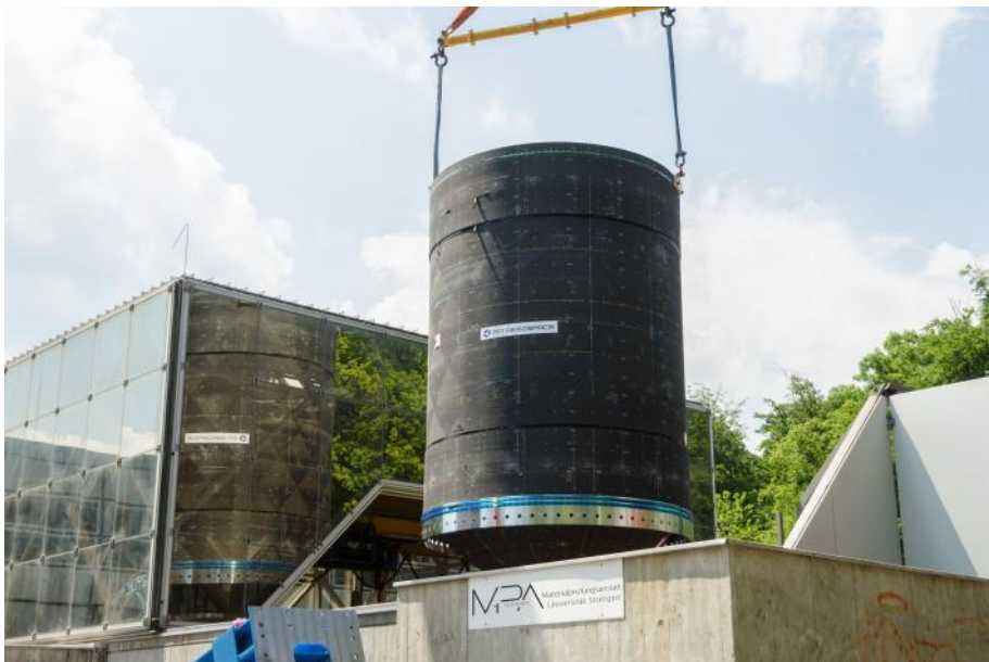
Der Booster-Demonstrator der neuen ARIANE 6 kurz vor dem Ablassen in den MPA-Prüfschacht. Foto: Universität Stuttgart/MPA
