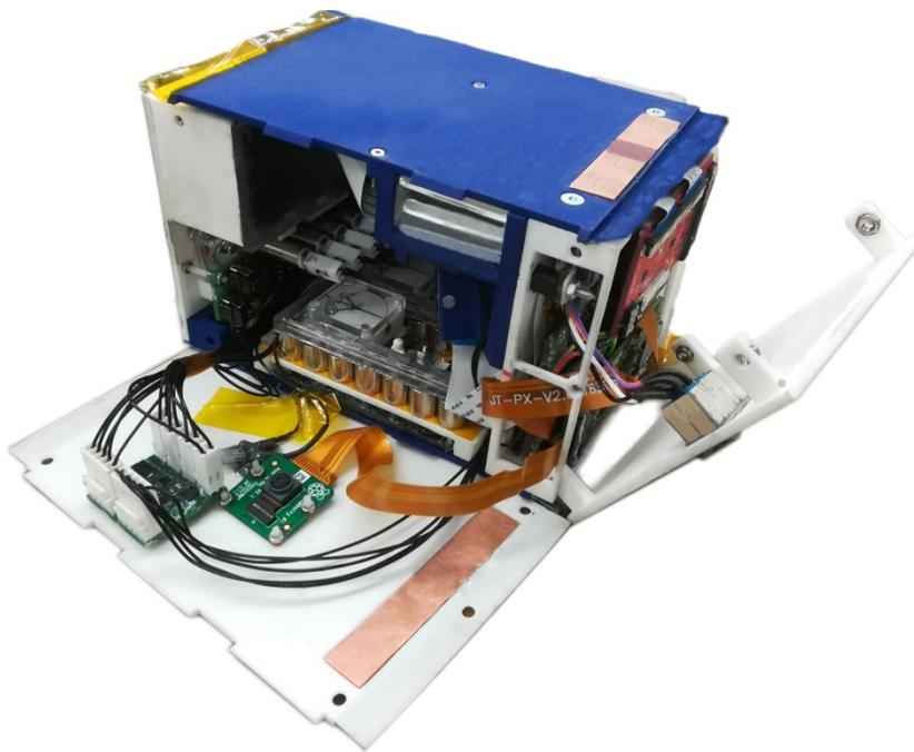
Bei dem PARELL Experiment handelt es sich um eine Pumpe ohne mechanisch bewegliche Teile, die als wartungsfreie Pumpe für Langzeitmissionen im All realisiert werden könnte. Foto: KSat
