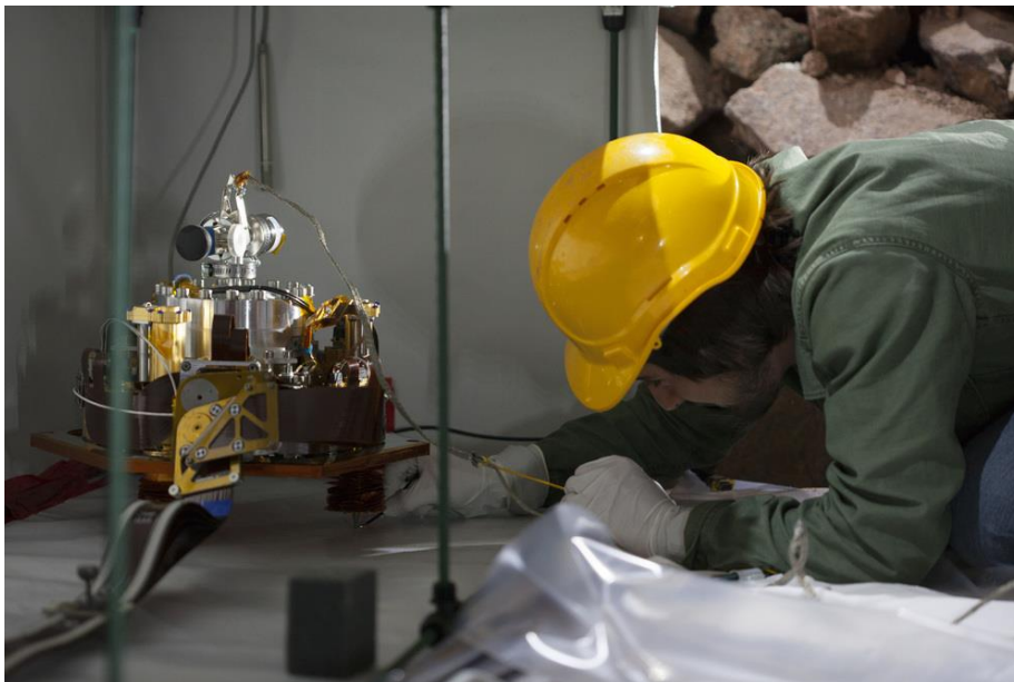
Das SEIS Instrumentenpaket während der Installation im Teststollen des BFO, 110m unter der Erdoberfläche. Foto: Biörn Oldsen
