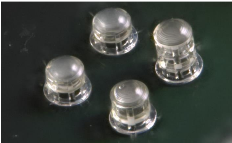
Detailfoto der vier verschiedenen Linsen auf dem CMOS-Sensorchip. © Universität Stuttgart/ PI 4
