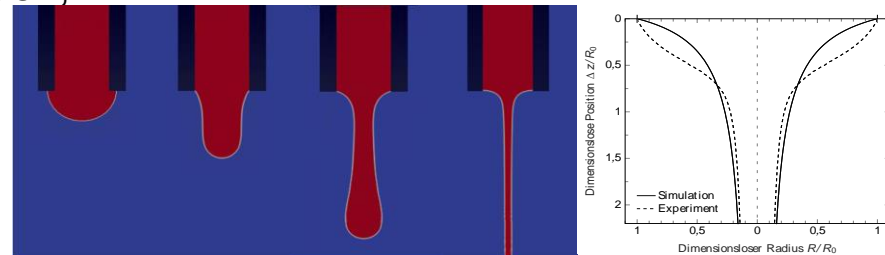
Beispielhafte Darstellung verschiedener Simulationsergebnisse: Links: Finite-Volumen-Methode. Rechts: Lagrange-Ansatz.
