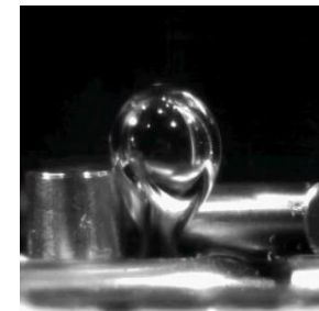
IMVT: Blasenabriss an Drahtgewebe
