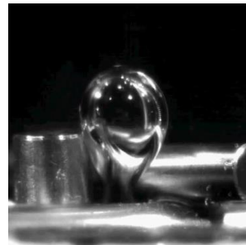
IMVT: Blasenabriss an Drahtgewebe
