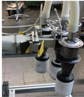
Versuchsstand zur Untersuchung von Multizyklonen
