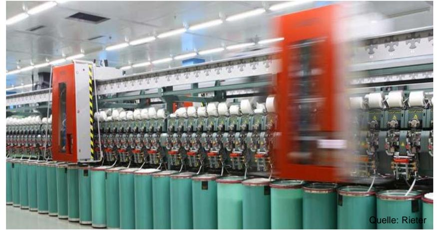
Vollautomatisierte Luftspinnmaschine 2014
