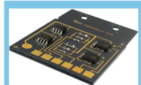
Testsubtrat mit gelöteten Bauelementen
