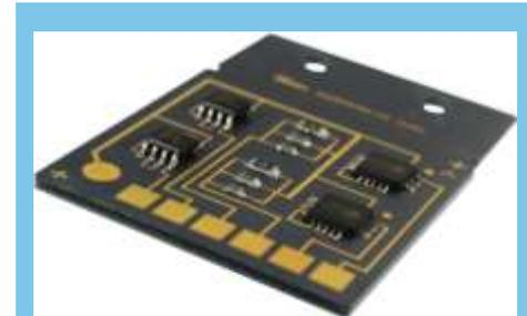
Testsubstrat mit gelöteten Bauelementen
