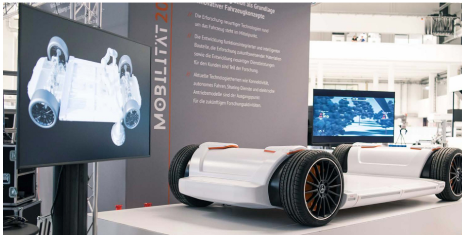
In diesem Rolling Chassis liegen die Grundlagen für die cyberphysischen Fahrzeuge der Zukunft. Foto: ARENA2036
