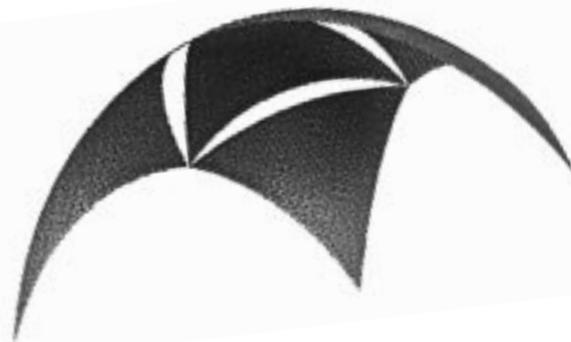
Die Approximation von Flächen mit hoher Genauigkeit ist nur ein Beispiel aus der Vielfalt der Forschungsarbeiten des Kollegs; die Abbildung zeigt die kubische Approximation einer Kugel.
