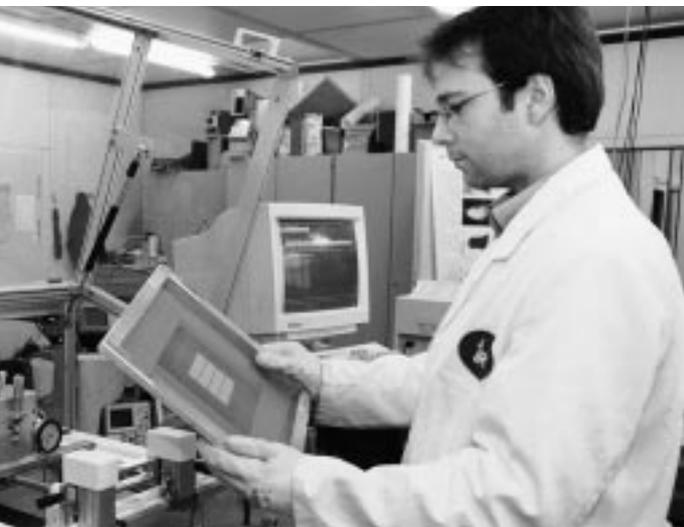
uf dem Weg zum eigenen Unternehmen sind drei Mitarbeiter des Instituts für Raumfahrtssysteme. Grundlage ist ein Sensor zur multianalen Messung von Massenstrom und Sauerstoffpartialdruck. Unser Foto zeigt einen Teilschritt der Sensorherstellung. Mit Siebdruckverfahren werden dabei planare Elemente in mehreren Schichten produziert. Dafür werden Schablonen benötigt, die einer der drei Gründer, Frank Hammer, in Händen hält. (Foto: Eppler)
