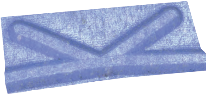
3D-Lasermikroskopaufnahme einer Rückförderstruktur.
