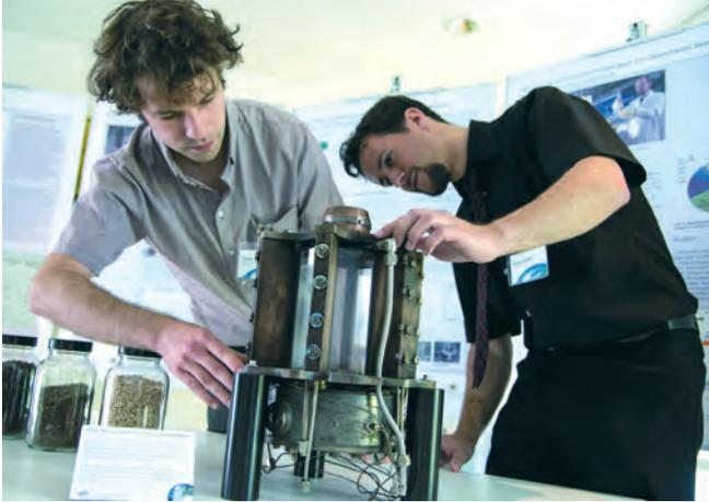
Durch Vergärung von Klärschlamm und Vergasung von Holzpellets können die Wissenschaftler Gas erzeugen. In der gläsernen Gasturbinen-Forschungsbrennkammer analysieren sie mit Hilfe von Lasern die Flammeigenschaften. (Foto: DLR)
