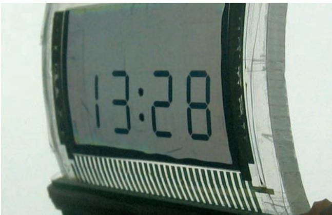
Flüssigkristalldisplay mit Kohlenstoff-Nanoröhren als transparente Segmentelektroden. (Fotos: Institut)
