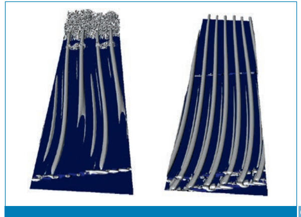
Wirbelbildung ohne (li.) und mit UFD-Aktuatoren (re.); Strömung von unten nach oben.
