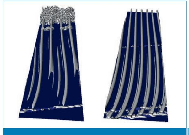
Wirbelbildung ohne (li.) und mit UFD-Aktuatoren (re.); Strömung von unten nach oben.
