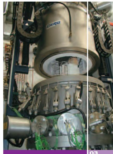
Neuer Prüfstand für druckaufgeladenen Betrieb von Hochtemperaturbrennstoffzellen
