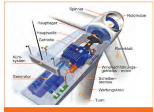
*Stall-geregelte Anlage • Aufbau einer stall-geregelten Windenergieanlage mit Getriebe und konstanter Drehzahl der Firma NEG-Micon (Grafik: Bundesverband Windenergie)*
