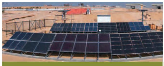
Jeweils dreizehn verschiedene Photovoltaikanlagen in Stuttgart (oben), Nikosia (Mitte) und Kairo (unten) dienen dazu, den Jahresenergieertrag der unterschiedlichen Technologien für Solarmodule (kristallines Silizium, amorphes Silizium, Cu(In,Ga)Se<sub>2</sub> und CdTe) unter verschiedenen klimatischen Bedingungen zu erforschen. Je nach Material findet man Unterschiede in der Abhängigkeit der Wirkungsgrade von Temperatur und Beleuchtungsstärke.
