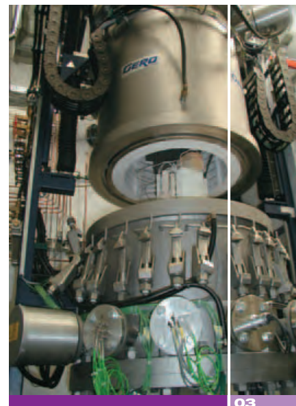
Neuer Prüfstand für druckaufgeladenen Betrieb von Hochtemperaturbrennstoffzellen
