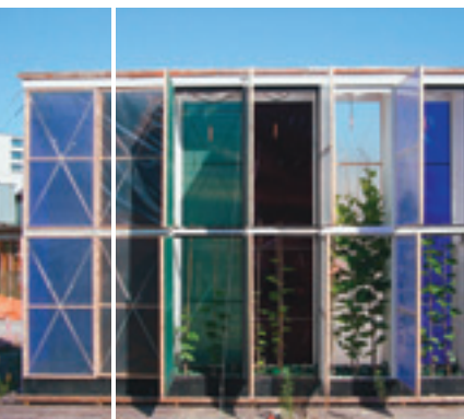
Links: Versuchsgewächshaus zur Produktion von baubotanischem Pflanzenmaterial, rechts: Wirkung der Lichtspektren auf das Längenwachstum, © FG Baubotanik – Lebendarchitektur
