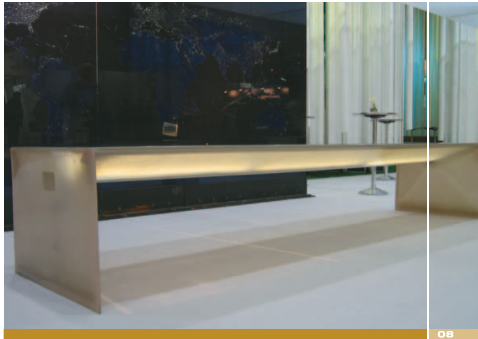
Tisch glasstec 2004: Transluzenter GFK-Körper mit eingeklebter Tischplatte aus Glas. Beide Komponenten spannen im Verbund über vier Meter (Entwurf itk2, Konstruktion und Herstellung itke).
