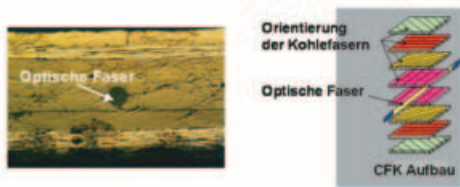
Integrierter Bragg-Gitter-Sensor zur Strukturüberwachung in einem Faserverbundlaminat
