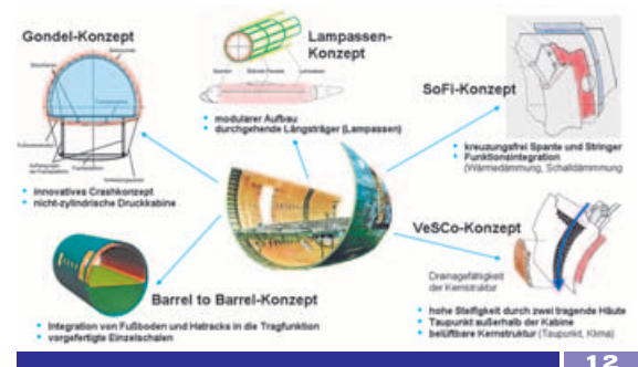
Multifunktionales Leichtbaukonzept für einen Verkehrsflugzeugrumpf
