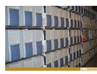
BioCORTEX Ein PC-Cluster bestehend aus 256 AMD MP1800+ Prozessoren
