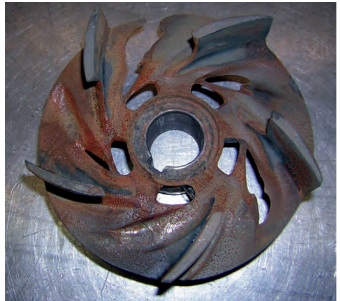
Schäden an einem Pumpenlaufrad, die durch Partikel und Späne in abrasiven Medien verursacht sind. (Fotos: Institut)
