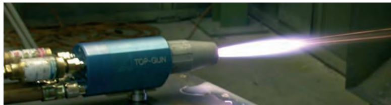
Das an der Uni Stuttgart entwickelte Hochgeschwindigkeits-Suspensions-Flammspritzverfahren. (Foto: Institut)
