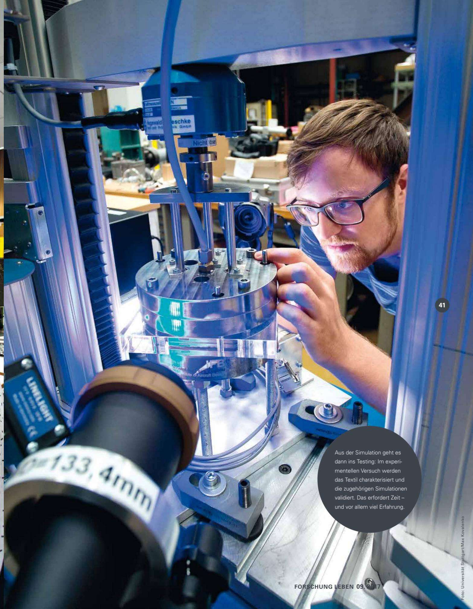
Aus der Simulation geht es dann ins Testing: Im experimentellen Versuch werden das Textil charakterisiert und die zugehörigen Simulationen validiert. Das erfordert Zeit – und vor allem viel Erfahrung.
