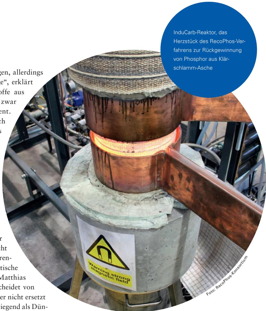
InduCarb-Reaktor, das Herzstück des RecoPhos-Verfahrens zur Rückgewinnung von Phosphor aus Klärschlamm-Asche
