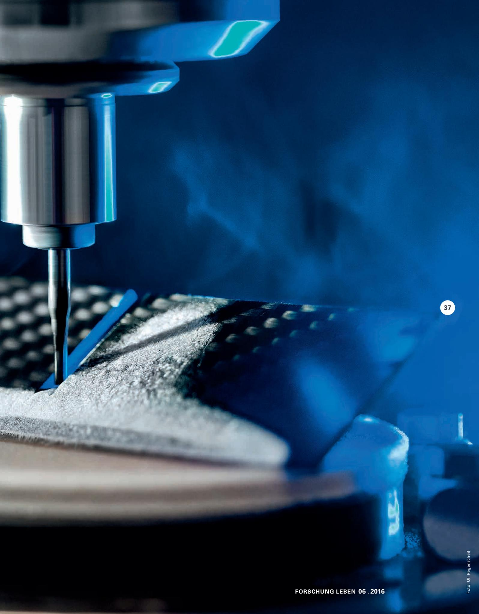
Die im Leichtbau weitverbreiteten carbonfaser-verstärkten Kunststoffe sind extrem schwierig zu bearbeiten. Am Institut für Strahlwerkzeuge werden sie durch Schäften (Anschrägen und Strukturieren) mittels Laser für eine Reparatur vorbereitet.
