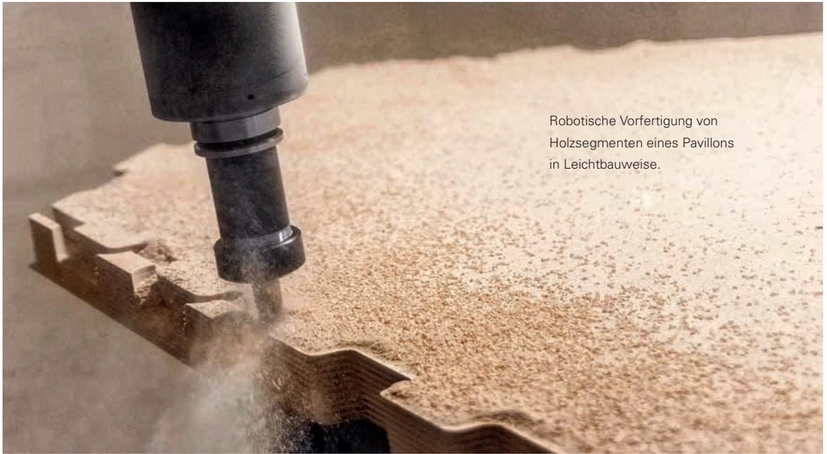
Robotische Vorfertigung von Holzsegmenten eines Pavillons in Leichtbauweise.
