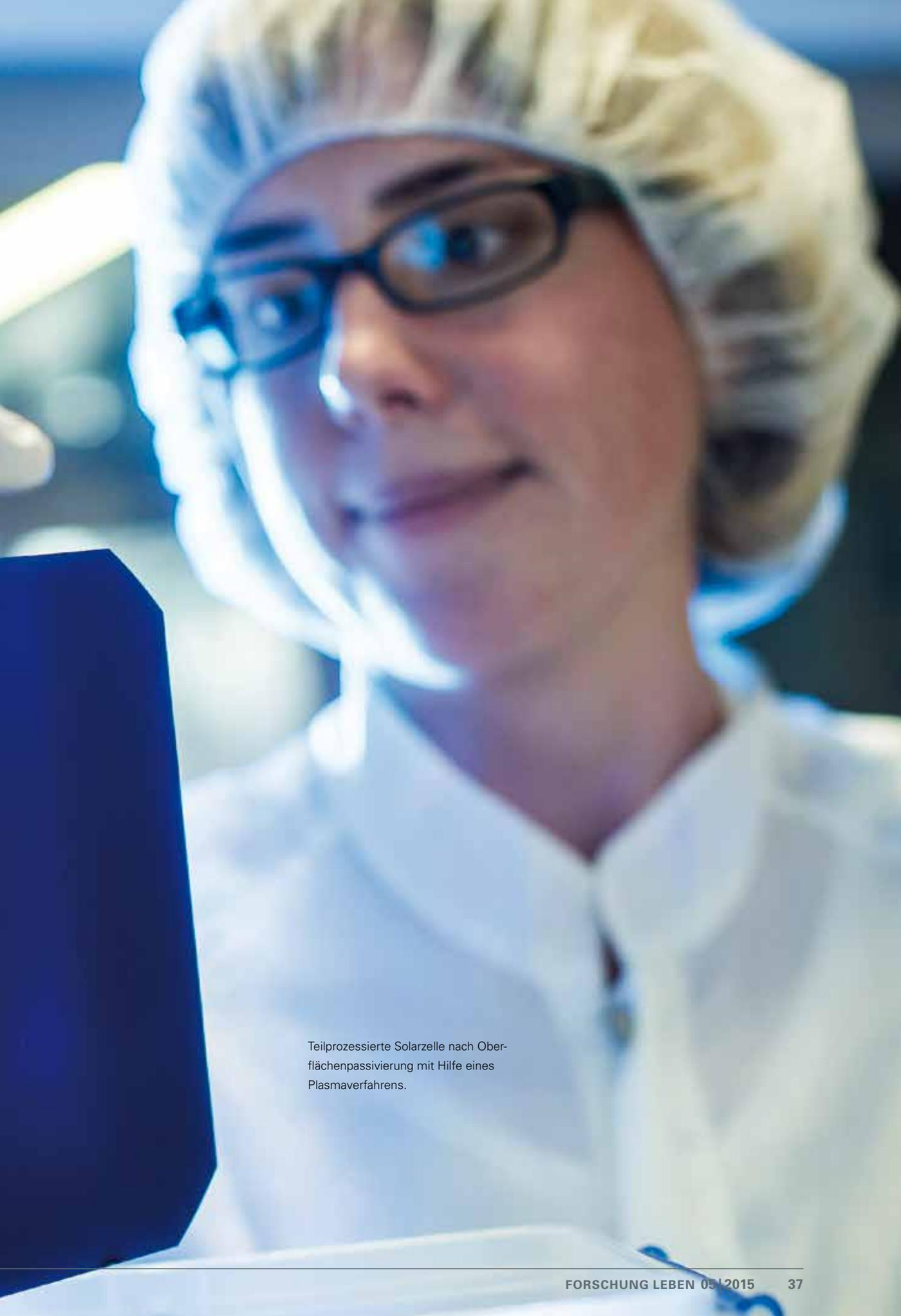
Teilprozessierte Solarzelle nach Oberflächenpassivierung mit Hilfe eines Plasmaverfahrens.
