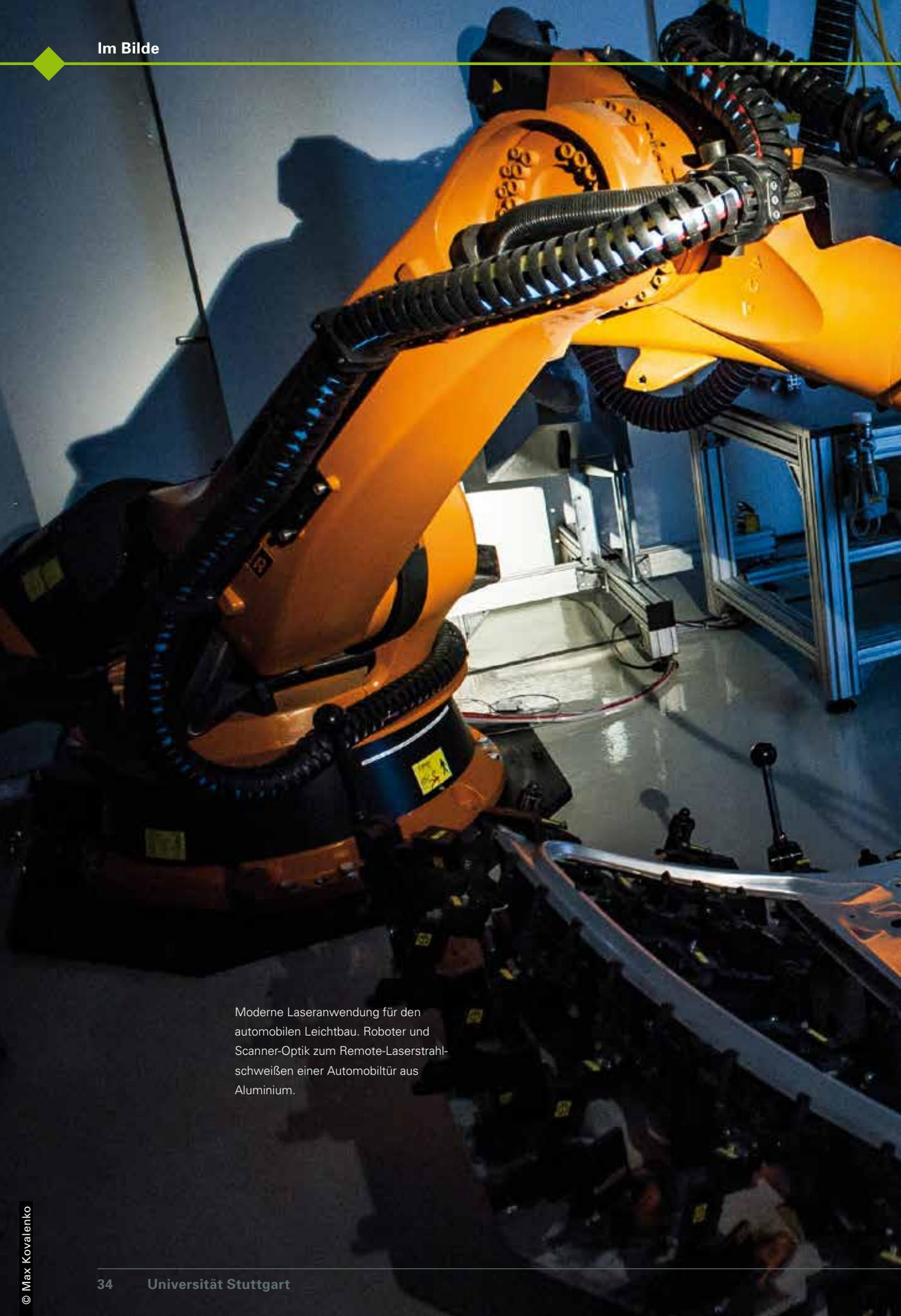
Moderne Laseranwendung für den automobilen Leichtbau. Roboter und Scanner-Optik zum Remote-Laserstrahlschweißen einer Automobiltür aus Aluminium.
