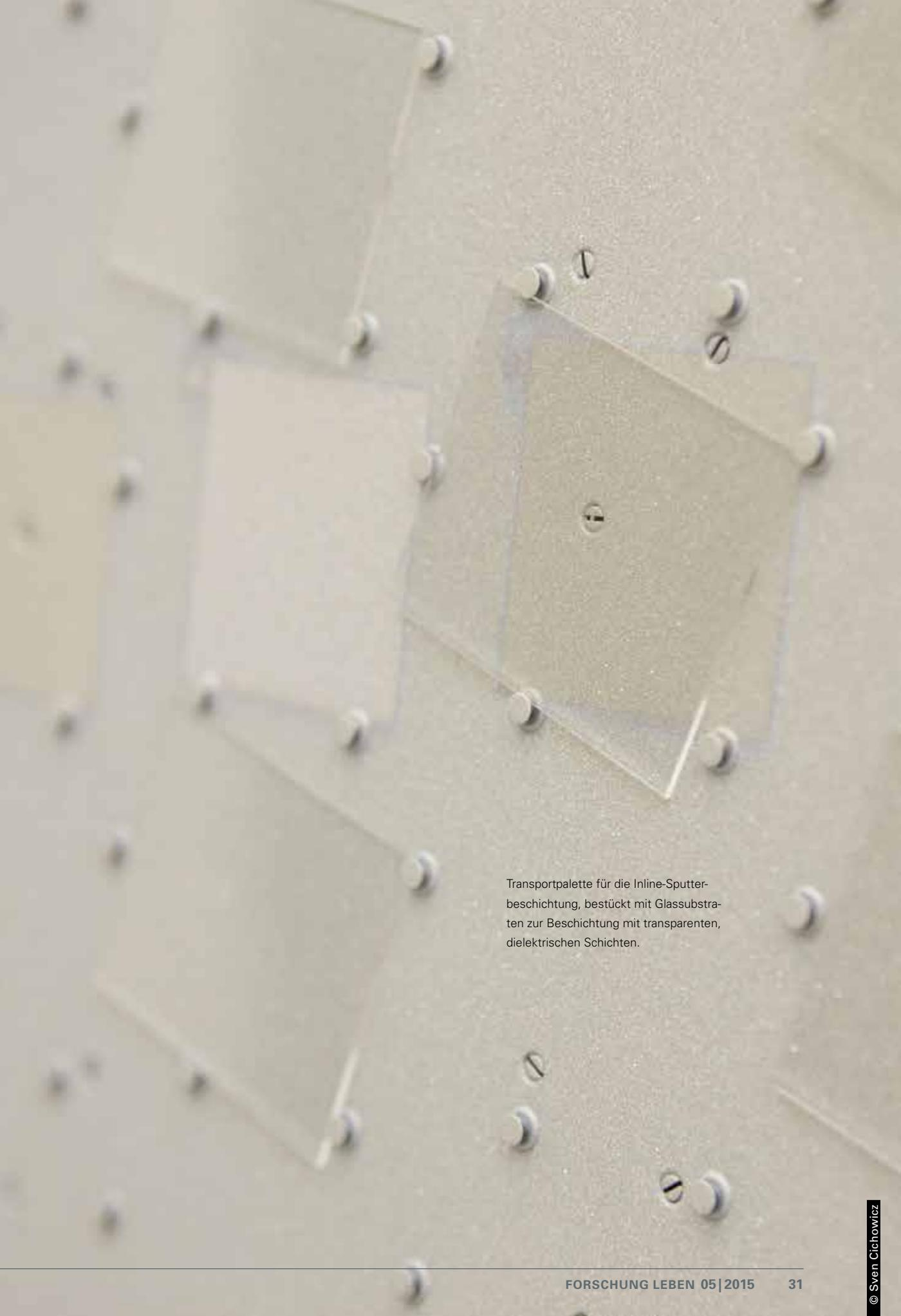
Transportpalette für die Inline-Sputterbeschichtung, bestückt mit Glassubstraten zur Beschichtung mit transparenten, dielektrischen Schichten.
