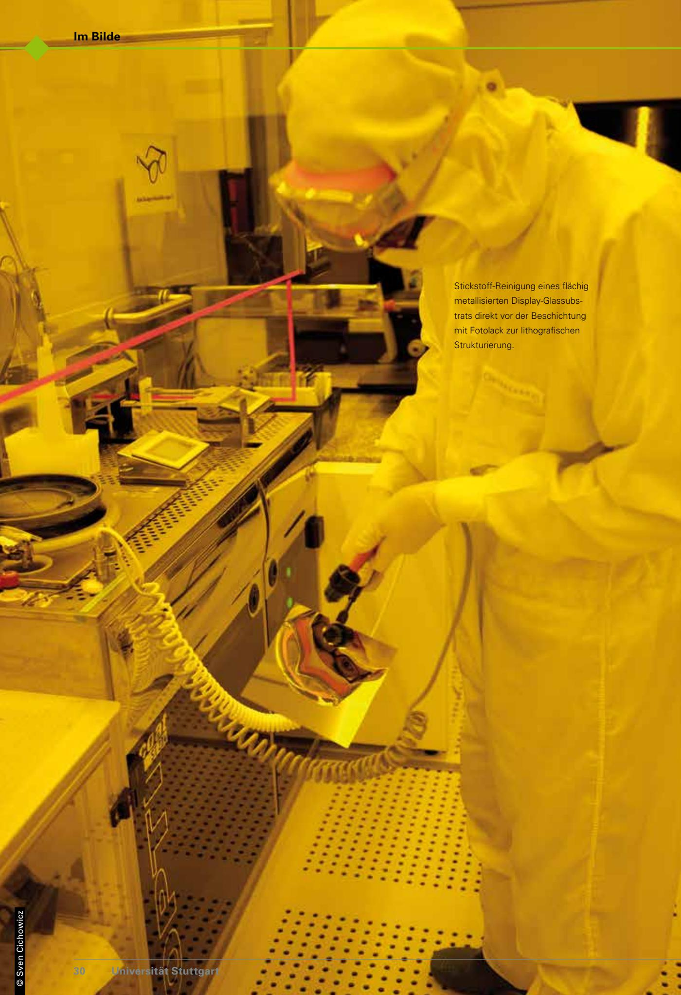
Stickstoff-Reinigung eines flächig metallisierten Display-Glassubstrats direkt vor der Beschichtung mit Fotolack zur lithografischen Strukturierung.
