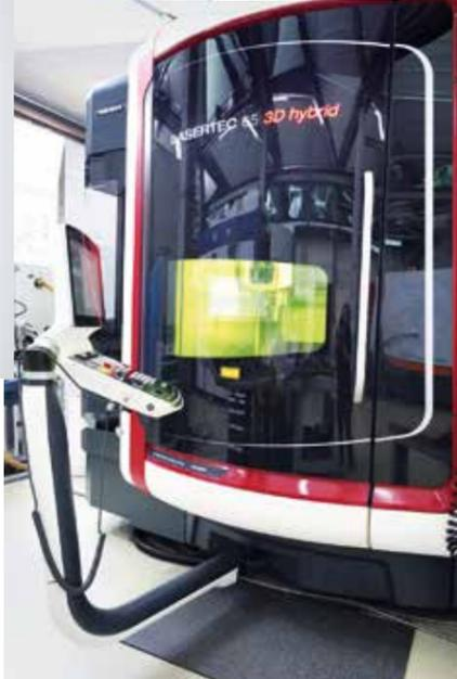
Keine Bahn, sondern ein moderner Arbeitsplatz: Diese Maschine ermöglicht eine hybride Bauteilfertigung.
