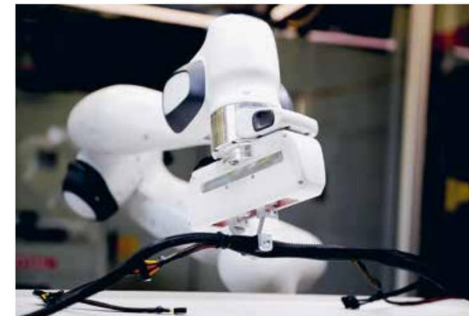
Einblick in die Arbeit am ISW: Mit Hilfe einer Steuerungssoftware soll der Roboter lernen, Objekte wie ein Kabel richtig zu lokalisieren und zu greifen.
