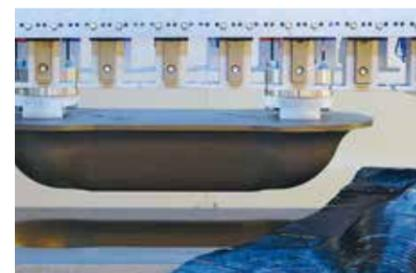
Auf dem Drapierteststand wird das Textil in 3D-Form gebracht.
