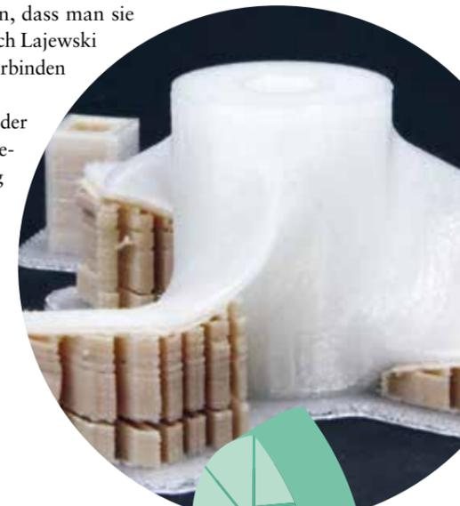
**Biologisch abbaubar: eine Stützstruktur aus Salz und Polymer**
