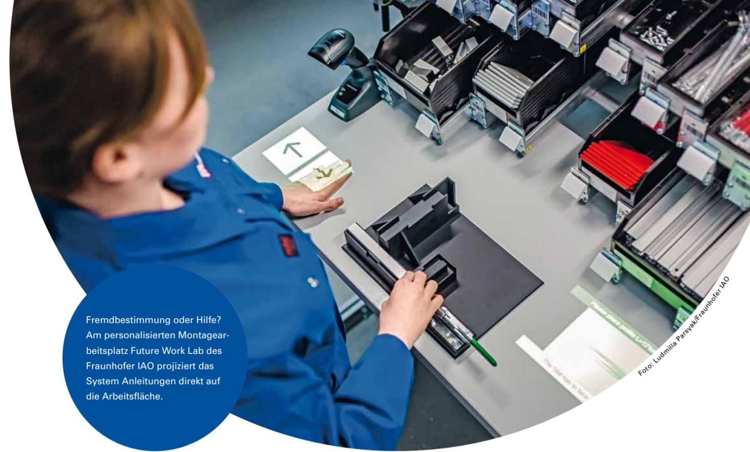
Fremdbestimmung oder Hilfe? Am personalisierten Montagearbeitsplatz Future Work Lab des Fraunhofer IAO projiziert das System Anleitungen direkt auf die Arbeitsfläche.
