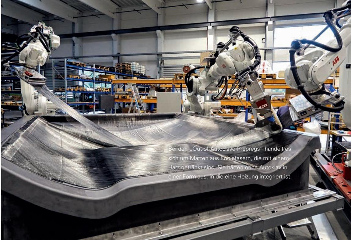
Bei den „Out-of-Autoclave-Prepregs“ handelt es sich um Matten aus Kohlefasern, die mit einem Harz getränkt sind. Sie härten ohne Autoklav in einer Form aus, in die eine Heizung integriert ist.
