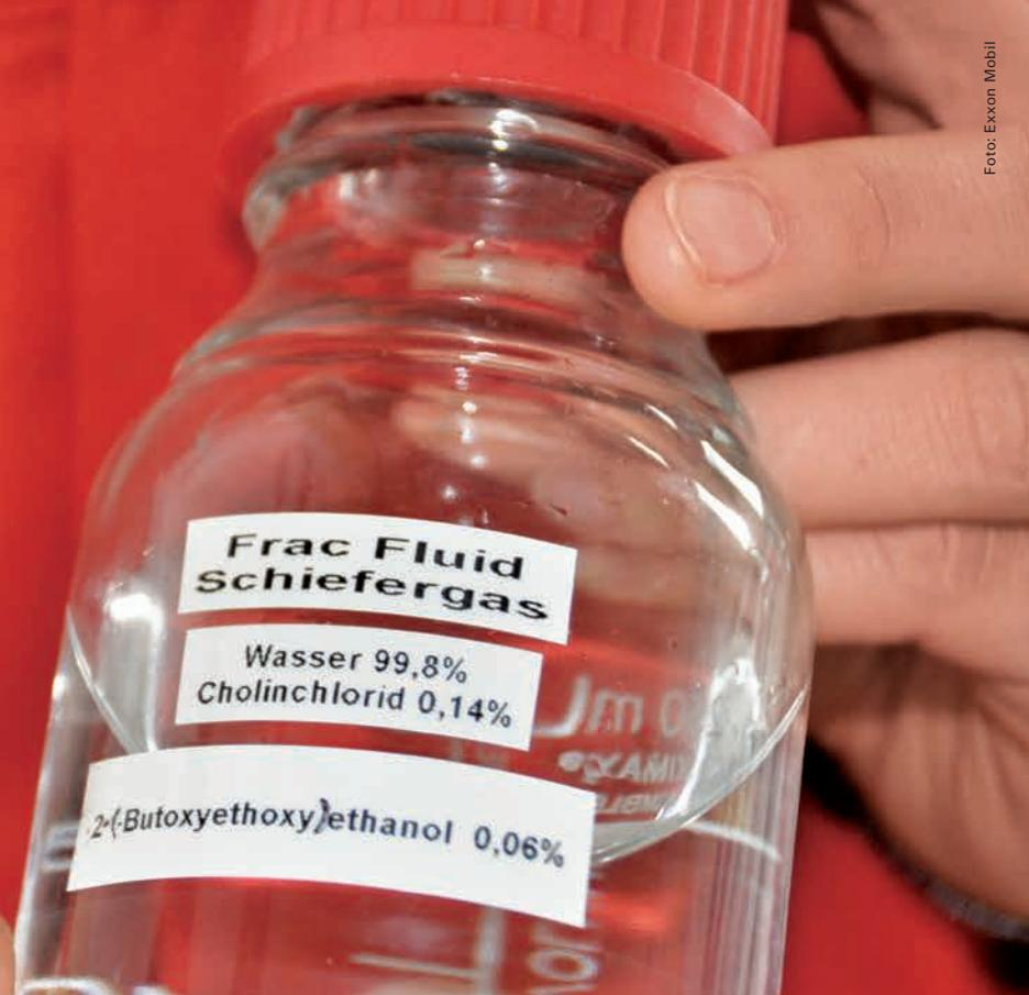
teils giftigen Chemikalien, in diese Schicht. Dieses laut ExxonMobil „schwach wassergefährdende Gemisch“ sprengt das Gestein auf und treibt Risse hinein, die namensgebenden Fracks. Auf diesem Weg lässt sich das gebundene Methan herauslösen und fördern. Am Ende des Prozesses wird das Fluid wieder aus dem Boden gepumpt und entsorgt.
