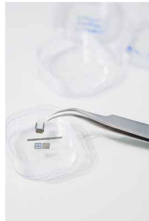
Präzisionsarbeit: Drahtlose Ultraschall-Aktoren zur Versorgung eines Miniatur-Endoskops.
