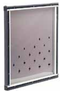
Fassadendemonstrator: Die integrierten Klappen können individuell geöffnet werden.
