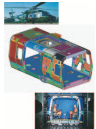
Kohlefaserverbundzelle für den militärischen Hubschrauber NH90 mit sehr guten Crasheigenschaften.
