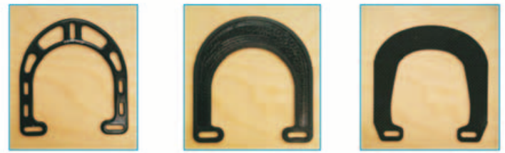
Fahrrad-Brakebooster aus Metall, konventionellen und gestickten Verbundwerkstoffen
