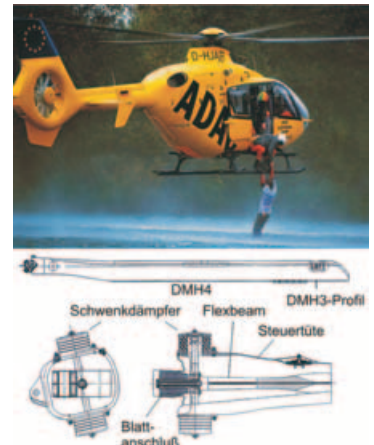
Das Hauptrotorblatt der EC 135 mit mehreren integrierten Funktionen.
