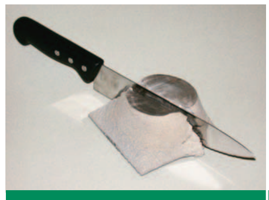
Lichtbogendrahtgespritzter Bolzen aus AlSi6, erhitzt in das Thixo-2-Phasengebiet und mit geringer Kraft zerteilt.
