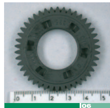
Zahnrad aus sinterfähigem Kohlenstoff, gepresst auf Hydraulikpresse mit Mehrebenenwerkzeug.
