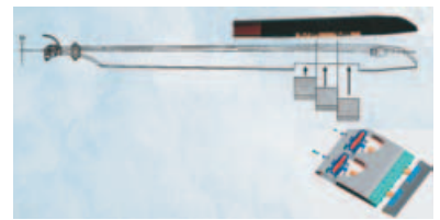
Forschungsrotorblatt der EC 145 mit piezoelektrisch angetriebenen Klappen.
