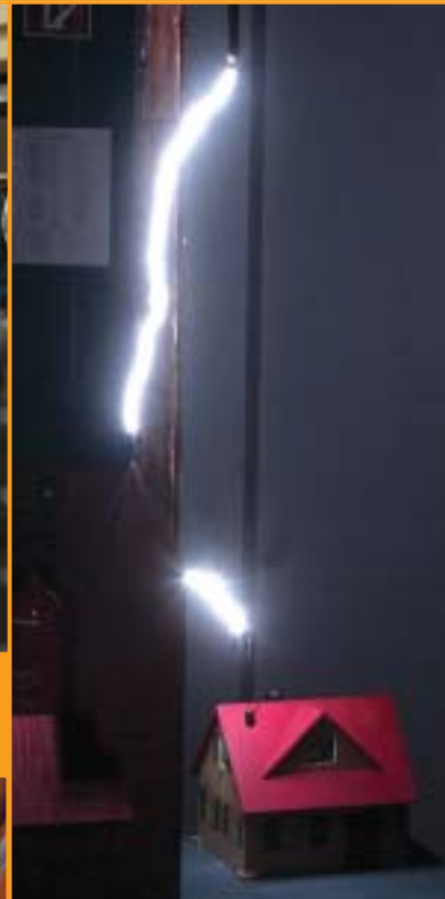
... doch Blitzschläge mit 500.000 Volt gab es am Institut für Energieübertragung und Hochspannungstechnik: zum Glück nur im Modell...
