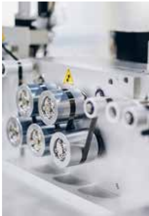
Feinarbeit: Kohlenstofffasern werden mechanisch gespreizt.
